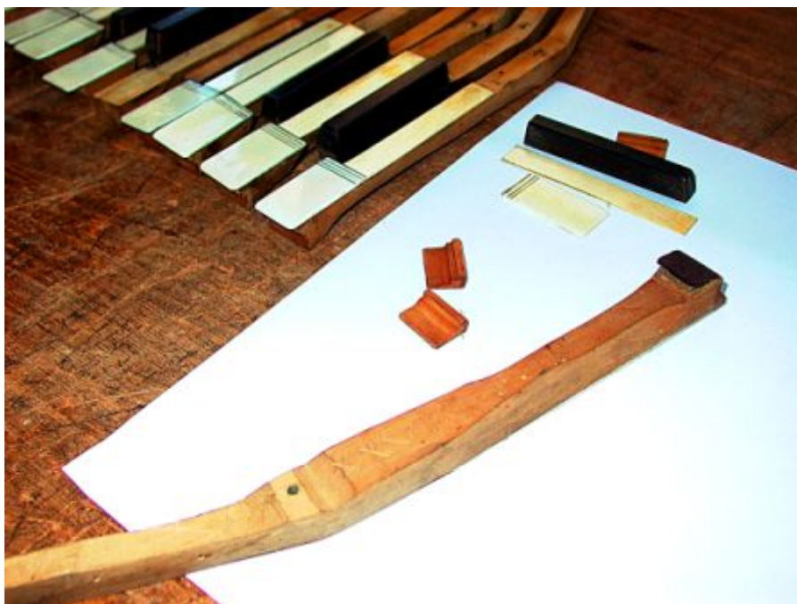
Fig. 4 Les touches et les flipots
